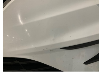
Tampon, ön, Ön tampon > Çatlak
