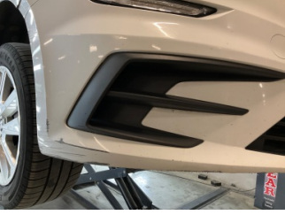
Tampon, ön, Ön tampon > Çatlak
