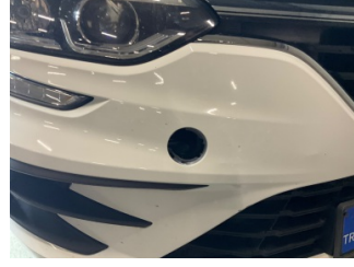
Tampon, ön, Çeki demir kapağı > Sökülmüş-Yok
