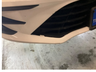
Tampon, ön, Ön tampon > Sabitlemesi Hatalı
