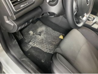
Taban, Pasparlar > Hasarlı
