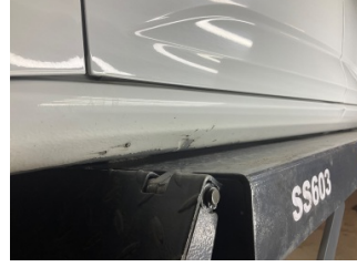
Marşbiyel, sol, Marşbiyel, sol > Boyası Atmış
