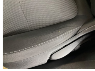
Döşemeler/Kapaklar, Döşemeler/Kapaklar > Yakıcı Madde ile Zarar Görmüş
