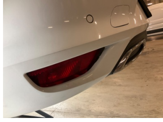
Tampon, arka, Reflektör, sol > Sabitlemesi Hatalı
