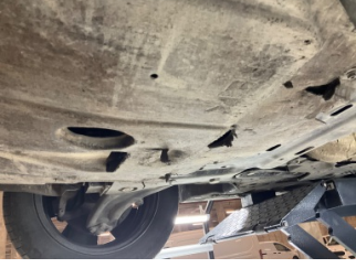
Motor, Alt muhafaza > Hasarlı
