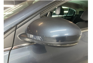
Dikiz aynası, sol, Dış dikiz aynası > Çizik
