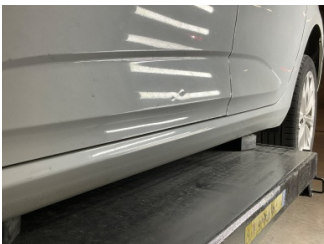
Kapı, sol ön, Kapı, sol ön > Ezik
