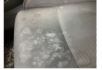
Döşemeler/Kapaklar, Döşemeler/Kapaklar > Yakıcı Madde Ile Zarar Görmüş
