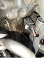
Motor, Külbütör kapağı > Yağ Kaçağı
