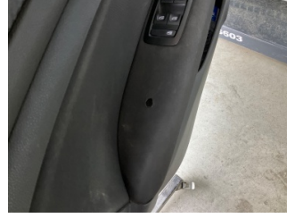
Döşemeler/Kapaklar, Döşemeler/Kapaklar > Yakıcı Madde Ile Zarar Görmüş
