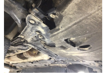
Motor, Alt muhafaza > Hasarlı
