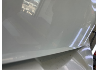
Bagaj kapağı/kapısı, Bagaj kapısı > Noktasal Ezik
