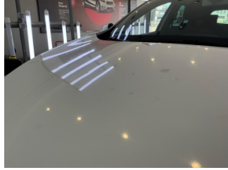
Motor kaputu, Motor kaputu > Dolu Hasarı
