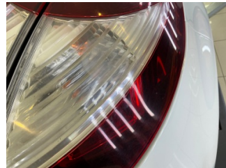
Arka lambalar, Arka lamba camı, sağ > Çatlak
