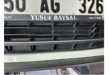
Tampon, ön, Ön tampon ızgarası > Hasarlı
