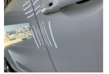
Kapı, sağ arka, Kapı, sağ arka > Ezik
