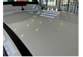
Tavan, Tavan > Dolu Hasarı
