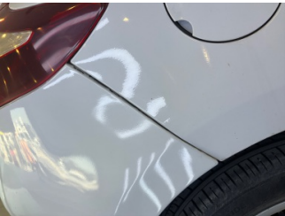
Tampon, arka, Arka tampon > Sabitlemesi Hatalı
