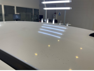
Tavan, Tavan > Dolu Hasarı
