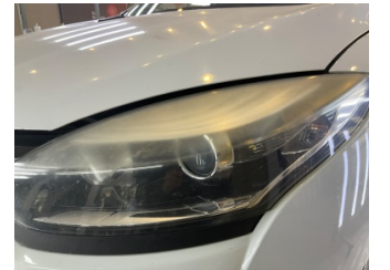
Farlar, Far camı, sol > Deforme Olmuş
