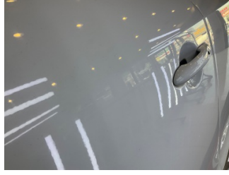
Kapı, sol ön, Kapı, sol ön > Ezik
