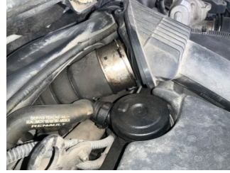
Motor, Turbo hortumları > Yağ Kaçağı
