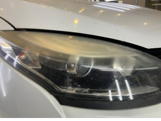
Farlar, Far camı, sağ > Deforme Olmuş
