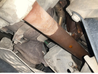
Motorsoğutması, Soğutma sıvısı > Sızdırıyor
