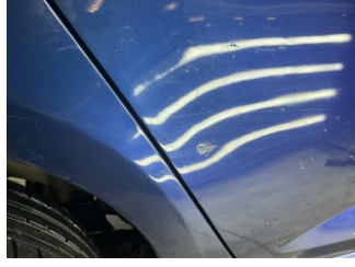
Kapı, sağ arka, Kapı, sağ arka > Ezik
