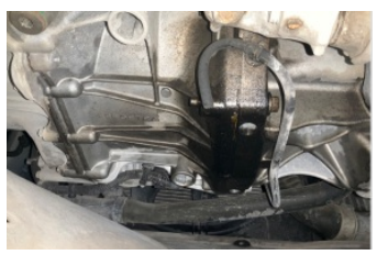
Motor, Motor > Yağ Kaçağı
