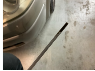
Motor, Yağ seviyesi > Eksik
