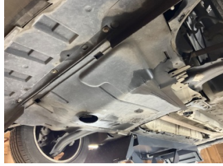
Motor, Alt muhafaza > Hasarlı
