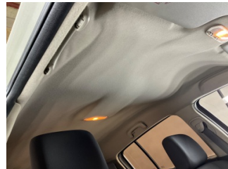
Döşemeler/Kapaklar, Döşemeler/Kapaklar > Deforme Olmuş
