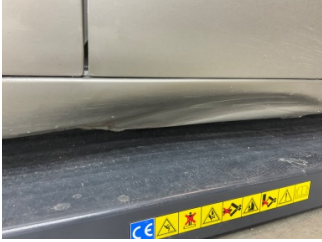
Marşbiyel, sağ, Marşbiyel, sağ > Hasarlı
