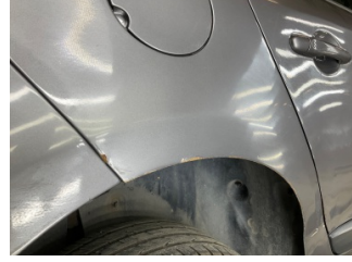
Çamurluk, sağ arka, Çamurluk, sağ arka > Pas
