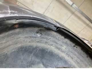
Çamurluk, sağ arka, Davlumbaz > Kırılmış
