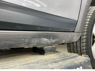
Marşbiyel, sağ, Marşbiyel, sağ > Hasarlı
