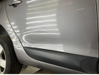
Kapı, sağ arka, Kapı, sağ arka > Ezik
