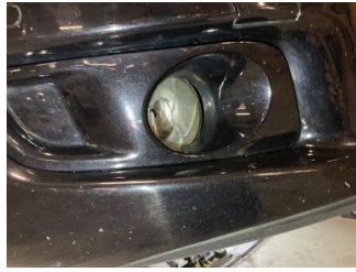
Sis lambaları, Sis farı camı, sağ > Hasarlı
