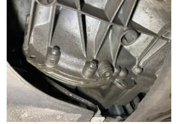
Şanzıman, Şanzıman > Yağ Kaçağı
