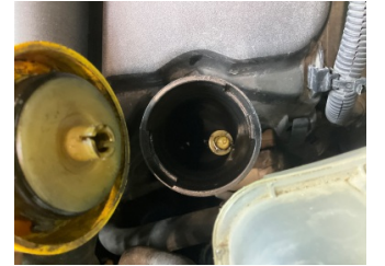
Motor, Yağ kontrol cubuğu > Sabitlemesi Hatalı
