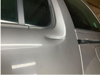
Kapı, sol arka, Kapı, sol arka > Hasarlı
