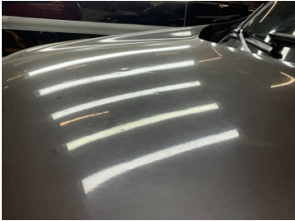
Motor kaputu, Motor kaputu > Dolu Hasarı
