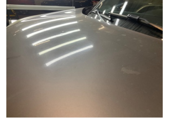
Motor kaputu, Motor kaputu > Dolu Hasarı
