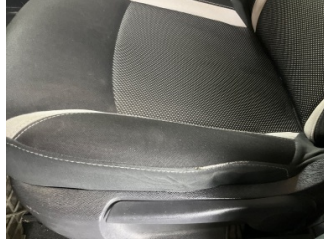
Döşemeler/Kapaklar, Döşemeler/Kapaklar > Deforme Olmuş
