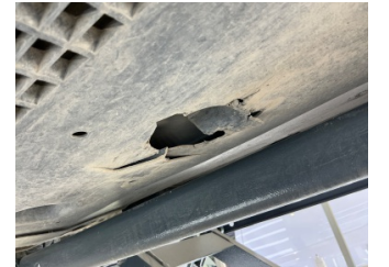
Kaporta, Muhafaza, orta > Hasarlı
