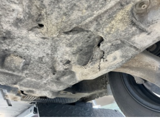
Motor, Alt muhafaza > Hasarlı
