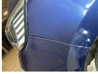
Tampon, ön, Ön tampon > Sabitlemesi Hatalı
