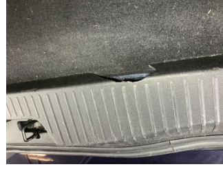
Döşemeler/Kapaklar, Yükleme eşiği kaplaması > Hasarlı
