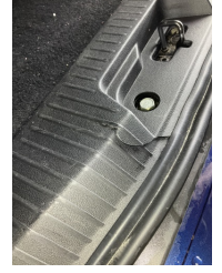
Döşemeler/Kapaklar, Yükleme eşiği kaplaması > Hasarlı
