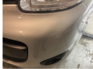
Tampon, ön, Ön tampon > Çatlak
