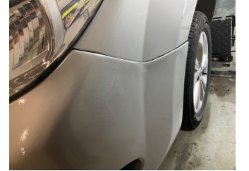
Tampon, ön, Ön tampon > Çatlak
