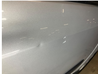
Kapı, sağ ön, Kapı, sağ > Ezik
