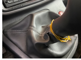
Şanzıman, Vites körüğü > Hasarlı
