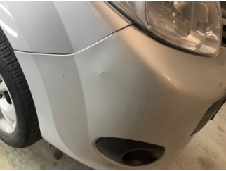
Tampon, ön, Ön tampon > Çatlak
