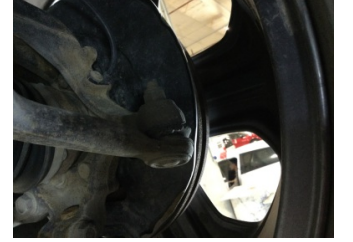
Direksiyon sistemi, Rot kolu/Rot başı, sağ > Hasarlı
