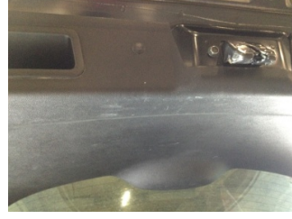
Döşemeler/Kapaklar, Döşemeler/Kapaklar > Çizik
