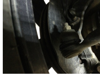
Direksiyon sistemi, Rot kolu/Rot başı, sol > Hasarlı
