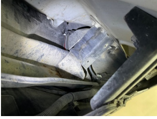
Tampon, arka, Bağlantı ayağı > Hasarlı
