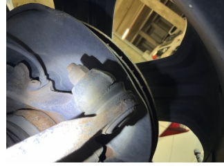
Direksiyon sistemi, Rot kolu/Rot başı, sağ > Hasarlı
