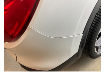
Tampon, arka, Arka tampon > Sabitlemesi Hatalı
