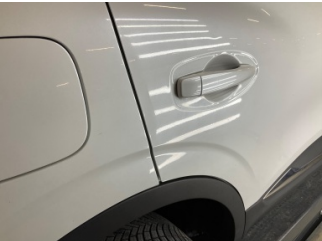
Kapı, sağ arka, Kapı, sağ arka > Ezik
