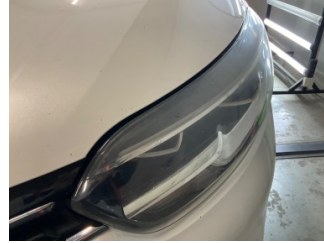
Farlar, Far camı, sol > Deforme Olmuş
