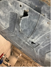
Motor, Alt muhafaza > Hasarlı
