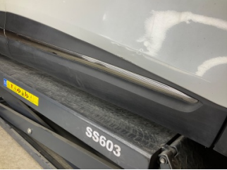
Kapı, sağ ön, Kapı bandı > Çizik
