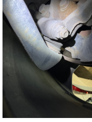
Ön aks, Salıncak, ön sağ alt > Hasarlı
