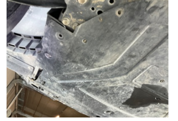
Motor, Alt muhafaza > Hasarlı
