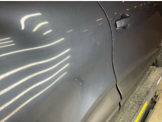
Kapı, sağ arka, Kapı, sağ arka > Ezik
