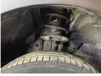
Ön aks, Amortisör körüğü, sağ > Hasarlı
