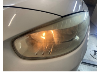
Farlar, Far camı, sol > Deforme Olmuş
