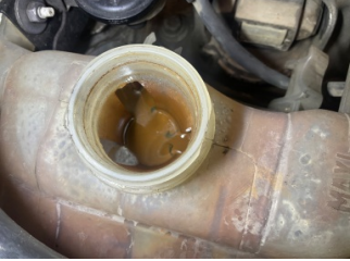
Motorsoğutması, Soğutma sıvısı > Kirlenmiş
