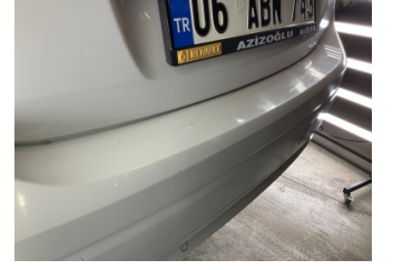
Tampon, arka, Arka tampon > Çatlak
