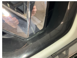
Motor kaputu, Amblem > Çatlak
