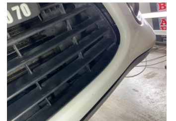
Tampon, ön, Ön tampon ızgarası > Hasarlı
