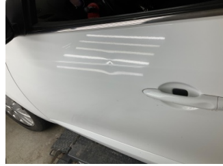
Kapı, sol ön, Kapı, sol ön > Vuruk
