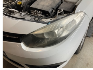
Farlar, Far camı, sol > Deforme Olmuş
