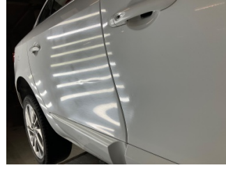
Kapı, sağ arka, Kapı, sağ arka > Ezik
