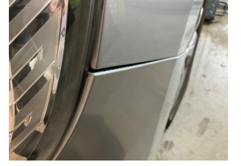
Tampon, ön, Ön tampon > Sabitlemesi Hatalı
