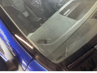
Camlar, Ön cam > Hasarlı
