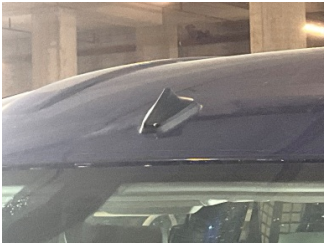
Komünikasyon/Navigasyon/EğlenceKapı, sağ arka, Kapı, sağ arka sistemleri, Anten > Sökülmüş-Yok > Hasarlı
