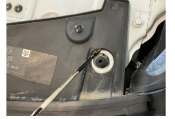
Motor, Yağ seviyesi > Eksik
