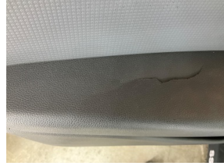
Döşemeler/Kapaklar, Kapı döşemesi, sol ön > Hasarlı
