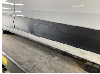
Kapı, sağ ön, Kapı bandı > Çizik
