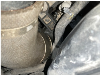
Motor, Turbo hortumları > Yağ Kaçağı
