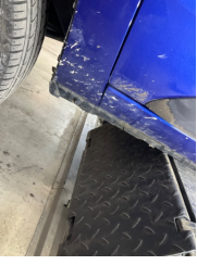
Çamurluk, sol, Çamurluk, sol > Deforme Olmuş
