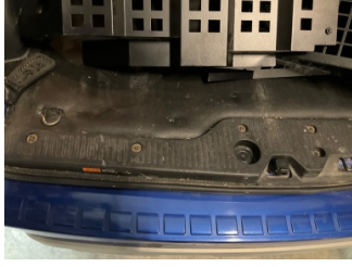
Döşemeler/Kapaklar, D-direk iç kaplaması, sol > Kirlenmiş
