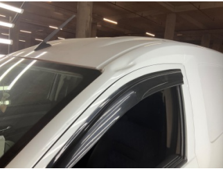
Tavan, Ön cam direği, sol > Hasarlı
