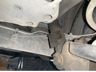
Arka aks, Amortisör, arka sağ > Yağ Kaçağı
