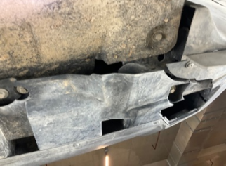
Tampon, ön, Tampon koruyucu orta > Hasarlı
