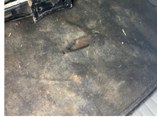
Döşemeler/Kapaklar, Bagaj bölümü döşemesi > Hasarlı
