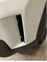
Tampon, ön, Ön tampon > Sabitlemesi Hatalı
