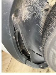
Çamurluk, sol, Davlumbaz > Sabitlemesi Hatalı
