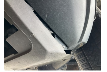
Tampon, ön, Tampon koruyucu sol > Hasarlı
