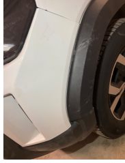
Tampon, ön, Ön tampon > Sabitlemesi Hatalı
