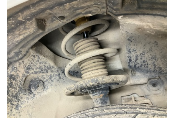
Ön aks, Amortisör körüğü, sağ > Hasarlı
