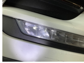
Sis lambaları, Sis farı camı, sağ > Çatlak
