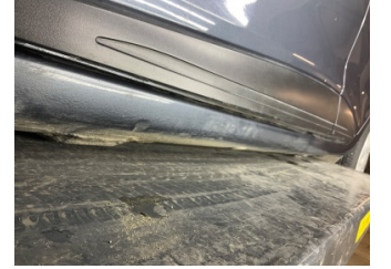
Kapı, sol ön, Kapı bandı > Çizik
