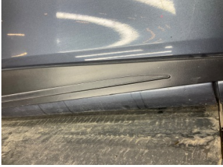
Kapı, sağ ön, Kapı bandı > Çizik
