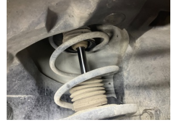
Ön aks, Amortisör körüğü, sağ > Hasarlı
