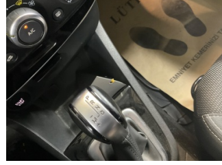
Şanzıman, Vites topuzu > Deforme Olmuş
