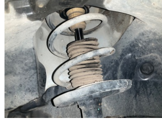
Ön aks, Amortisör körüğü, sol > Hasarlı
