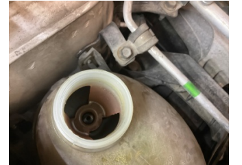
Motorsöğütması, Soğutma sıvısı > Kirlenmiş
