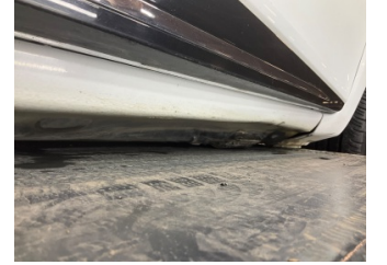
Marşbiyel, sağ, Marşbiyel, sağ > Hasarlı
