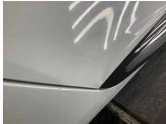
Kapı, sağ arka, Kapı, sağ arka > Ezik
