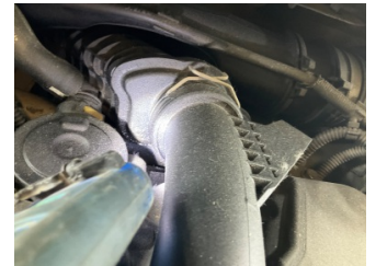
Motor, Turbo hortumları > Yağ Kaçağı
