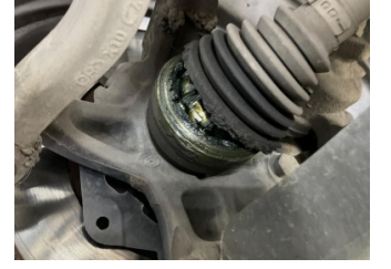
Ön aks, Aks mili, sağ > Hasarlı
