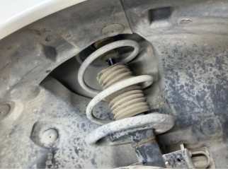
Ön aks, Amortisör körüğü, sağ > Hasarlı
