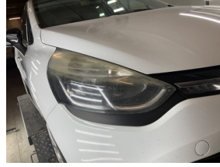
Farlar, Far camı, sağ > Deforme Olmuş
