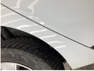
Çamurluk, sağ arka, Çamurluk, sağ arka > Küçük Vuruk
