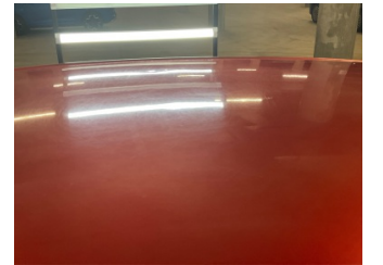
Tavan, Tavan > Dolu Hasarlı
