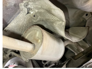
Kaporta, Muhafaza, arka > Hasarlı
