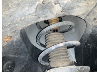
Ön aks, Amortisör körüğü, sağ > Hasarlı
