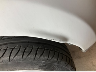
Tampon, arka, Arka tampon > Boyası Atmış
