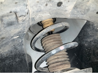
Ön aks, Amortisör körüğü, sol > Hasarlı
