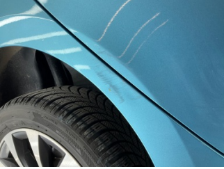
Kapı, sağ arka, Kapı, sağ arka > Çizik
