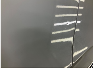
Kapı, sol ön, Kapı, sol > Noktasal Ezik
