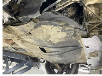
Motor, Alt muhafaza > Hasarlı
