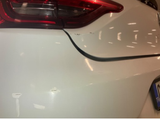
Bagaj kapağı/kapısı, Bagaj kapısı > Hatalı Ayarlanmış
