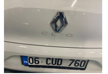
Bagaj kapağı/kapısı, Marka/Model Yazısı > Sökülmüş-Yok
