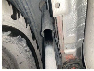
Arka aks, Amortisör, arka > Yağ Kaçağı
