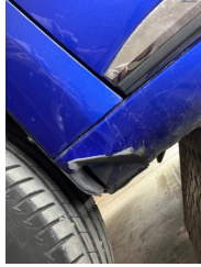
Marşbiyel, sol, Marşbiyel, sol > Hasarlı
