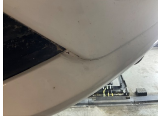
Tampon, ön, Ön tampon > Çatlak
