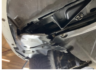
Tampon, ön, Tampon koruyucu sağ > Hasarlı
