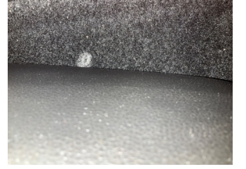
Döşemeler/Kapaklar, Döşemeler/Kapaklar > Yakıcı Madde ile Zarar Görmüş
