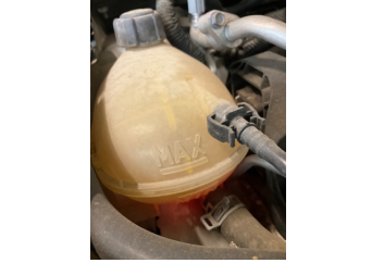
Motorsoğutması, Soğutma sıvısı > Eksik
