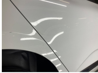
Kapı, sağ arka, Kapı, sağ arka > Çizik
